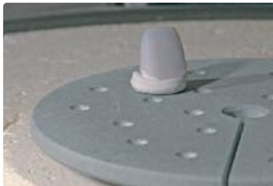
Colocar a bandeja de queima no forno e iniciar o programa de cristalização.
