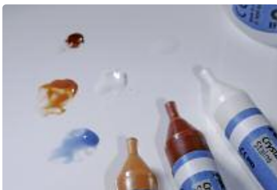
Expulsar IPS e.max Crystall./Shades e Stains das seringas e misturar totalmente. Se for necessário, afinar com IPS e.max CAD Crystall./Glaze Liquid.
