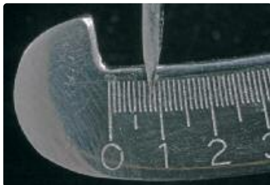
Checar se a espessura mínima da restauração foi mantida durante o acabamento.
